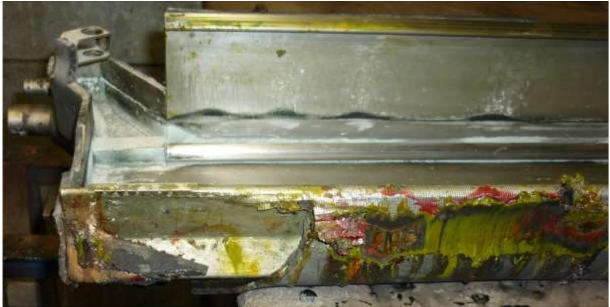
Alla bacinella è stato tolto il rivestimento in spugna originale ormai rovinato. Ora la bacinella è pronta per passare nella nostra macchina ad ultrasuoni dove subirà vari cicli di lavaggio e sgrassatura senza l'uso di solventi ma solo con acqua e la forza dell'ultrasuono.
